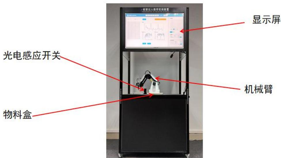
图 5-4 实训装置的结构布局
